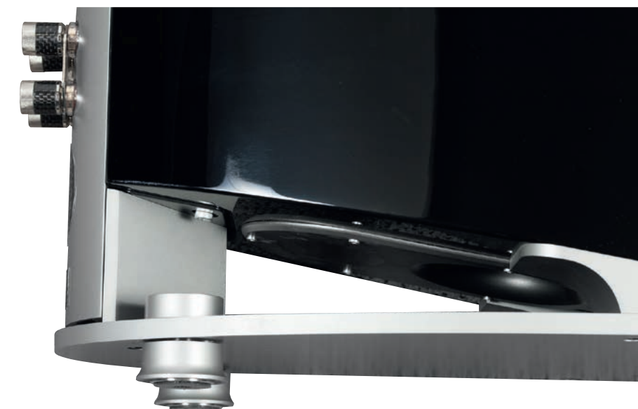
Klinowy przesłwit między cokołem a obudową służy wyprowadzeniu ciśnienia z tunelu bas-refleks – to kolejna konstrukcja z taką lokalizacją.
